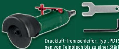
Druckluft-Trennschleifer; Typ „PDT5 6.3 C4“; zum Trennen von Feinblech bis zu einer Stärke von 3 mm; Bemessungsdrehzahl: 20.000 min<sup>-1</sup>; Druckluftanschluss: 1/4" (6,35 mm); Bemessungsluftdruck: max. 6,3 bar
